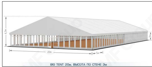
BIG TENT 20м. ВЫСОТА ПО СТЕНЕ 3м
